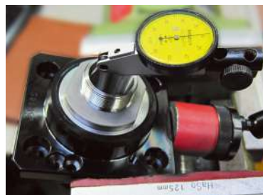
Inspeção da Extremidade de Saída
