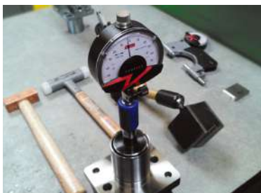
Inspeção da Extremidade de Entrada
