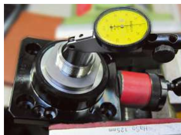
Inspection de l'extr mit  de sortie
