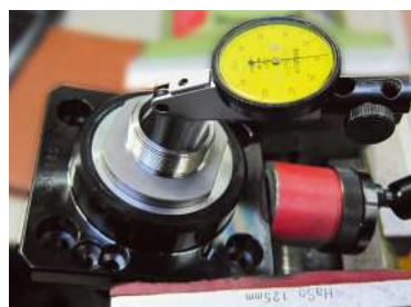
Проверка выходного конца
