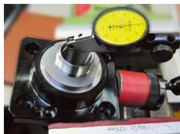
Inspection de l'extrémité de sortie
