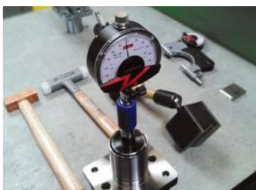
Inspección del Extremo de Entrada
