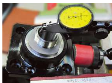
Inspección del Extremo de Salida
